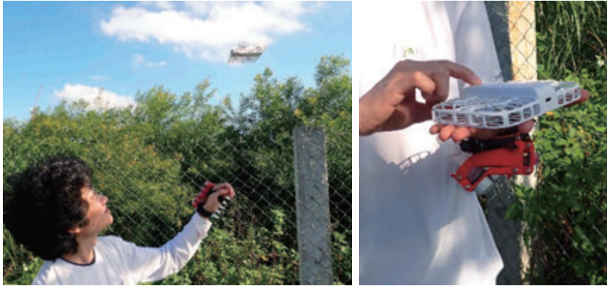
小型偵察用ドローンの運用実験。 プロペラが外枠によって保護されているため、損傷にも強い。
